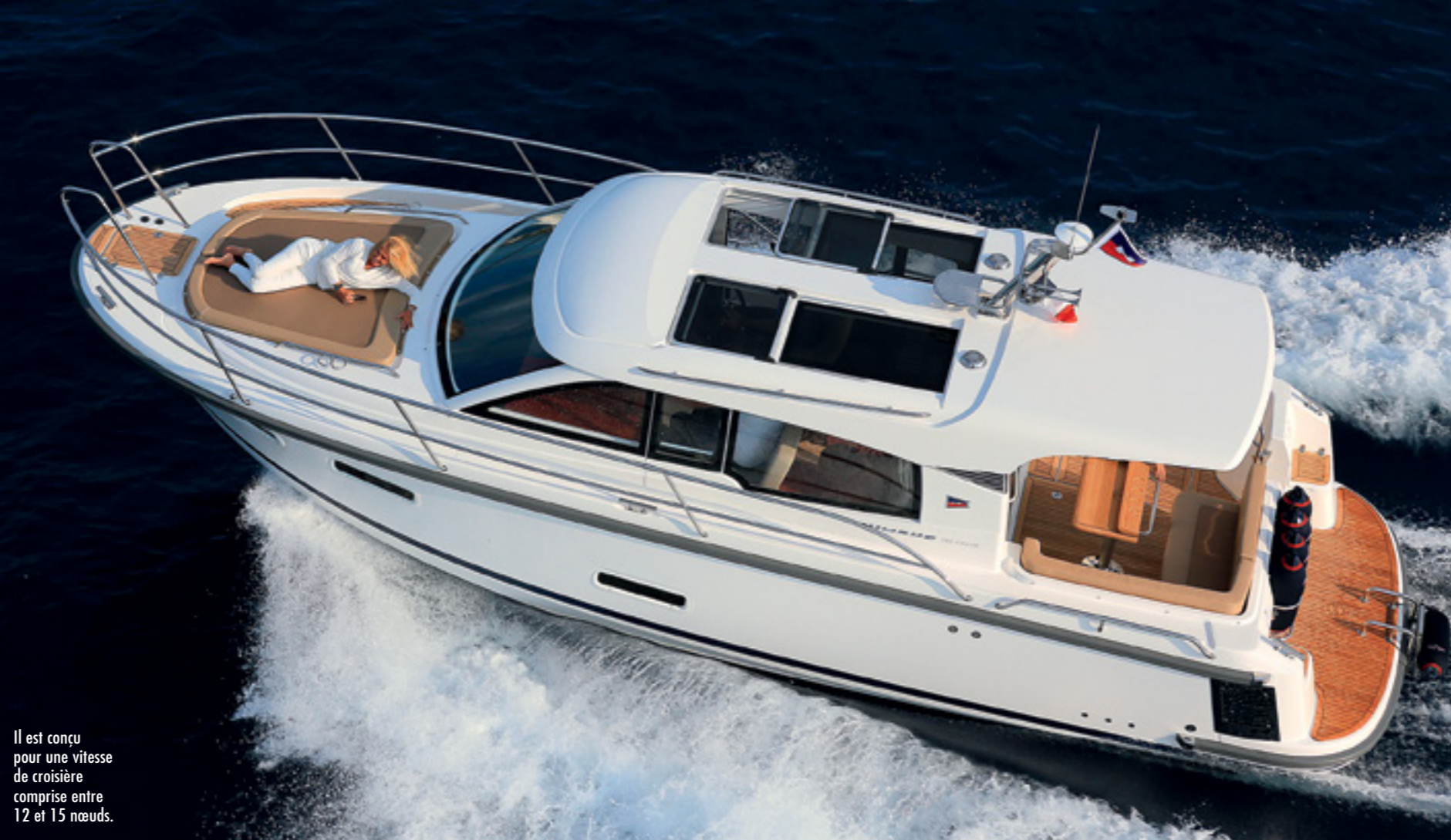
La carène semi-planante se cabre très peu à l'accélération.
