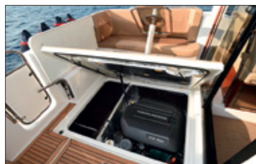
La transmission V-drive permet de reculer le moteur au maximum.
