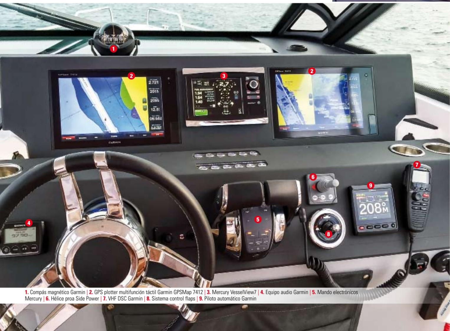
1. Compás magnético Garmin | 2. GPS plotter multifunción táctil Garmin GPSMap 7412 | 3. Mercury VesselView7 | 4. Equipo audio Garmin | 5. Mando electrónicos Mercury | 6. Hélice proa Side Power | 7. VHF DSC Garmin | 8. Sistema control flaps | 9. Piloto automático Garmin
